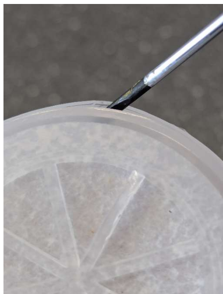
Рис. 5: Чтобы заправить смоляной картридж, снимите винтовую крышку и с помощью небольшой плоской отвертки осторожно вставьте её между стенкой корпуса и крышкой, чтобы поддеть и снять крышку с нетканым материалом.
