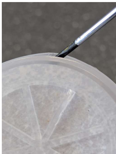
Fig. 5: Para rellenar el cartucho de resina, se retira el tapón de rosca y se levanta la tapa con el tejido no tejido con ayuda de un destornillador plano pequeño, introduciéndolo con cuidado entre la pared de la carcasa y la tapa.
